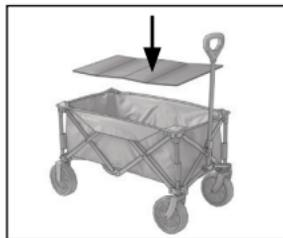
Instale el suelo desmontable en el panel de malla inferior.
